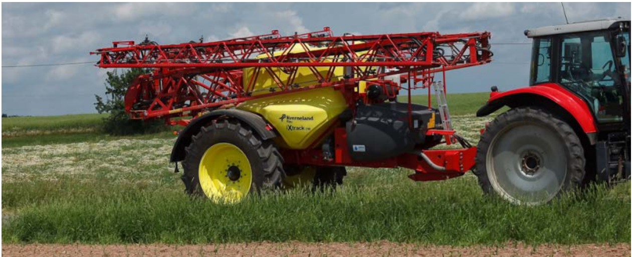
Barra diserbante HSS a 3 sezioni ripiegata sul serbatoio
