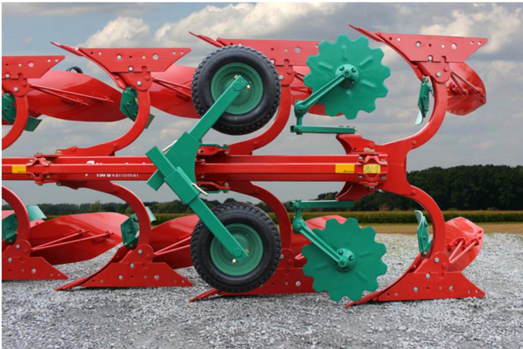
**La nuova ruota di profondità Kverneland montata sul telaio dell'aratro consente di lavorare più vicino a siepi, recinzioni e altri tipi di ostacoli; inoltre, grazie alla sua posizione, permette una maggiore superficie di aratura. Grazie a questo accorgimento, Kverneland rende la lavorazione del terreno più efficiente e redditizia.**
